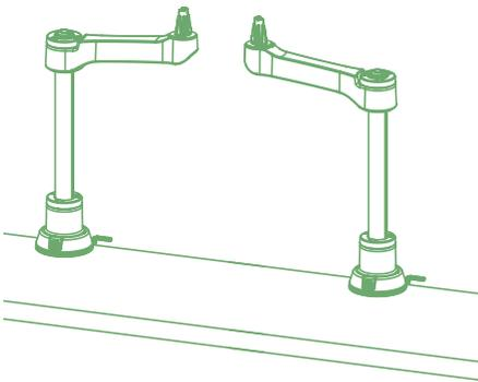
Drehen Sie den Arm und überprüfen Sie, ob er auf der gewählten Seite stoppt. Ist dies nicht der Fall, nehmen Sie den Unterarm von der Stange und setzen Sie ihn genau gegenüber auf die Stange. Drehen Sie ihn erneut, um zu überprüfen, ob er auf der gewünschten Seite stoppt. Drehen Sie den Unterarm in die richtige Position, sodass sich der Arm nicht nach hinten, sondern nur nach vorne bewegen kann.
