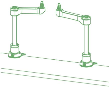
Gira el brazo y comprueba si se detiene en el lado elegido. Si no es así, retira el antebrazo del poste y colócalo exactamente en el lado opuesto del poste. Gíralo de nuevo para comprobar si se detiene en el lado deseado. Gira el antebrazo en la posición correcta de manera que el brazo no pueda moverse hacia atrás, sino solo hacia adelante.
