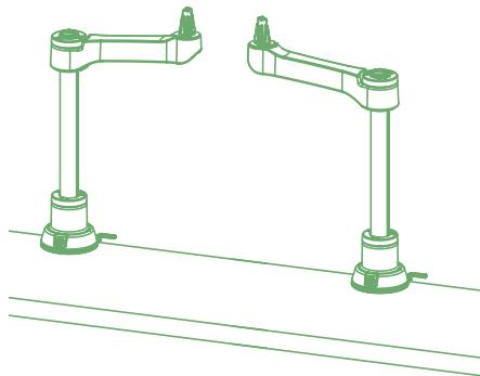
Drehen Sie den Arm und überprüfen Sie, ob er auf der gewählten Seite stoppt. Ist dies nicht der Fall, nehmen Sie den Unterarm von der Stange und setzen Sie ihn genau gegenüber auf die Stange. Drehen Sie ihn erneut, um zu überprüfen, ob er auf der gewünschten Seite stoppt. Drehen Sie den Unterarm in die richtige Position, sodass sich der Arm nicht nach hinten, sondern nur nach vorne bewegen kann.
