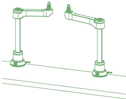
Gire o braço e verifique se ele para no lado escolhido. Se não, tire o antebraço do poste e coloque-o exatamente do lado oposto no poste. Gire-o novamente para verificar se ele para no lado desejado. Gire o antebraço na posição correta de forma que o braço não possa se mover para trás, mas apenas para a frente.
